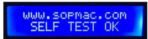
Una vez que el sistema compruebe el correcto funcionamiento y el test sea un éxito, empezará un conteo de 15 segundos antes de salir al aire. Este conteo se puede observar en la pantalla LCD del **TORINO 800**. Además nos muestra la frecuencia programada. Ejemplo:
