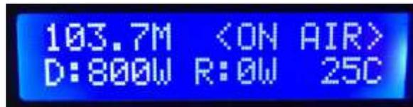
6.b.- En este momento ya estamos ALAIRE con la potencia que nos indica el wattimetro de la pantalla LCD. Subir o bajar la potencia de Transmisión se realiza a tiempo real y sin necesidad de cortar la transmisión. Solo Presione el pulsador "SET" y NO LO SUELTE hasta que en la pantalla LCD aparezca lo siguiente:
