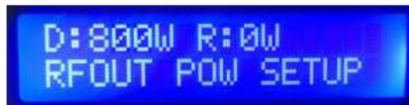
6.c.- Con la ayuda de los otros dos pulsadores "UP y DOWN" suba o baje la Potencia hasta donde usted desee. Si lo que usted requiere es, por ejemplo unos 480 Watts de potencia entonces, pulse el boton "DOWN" (cuando se encuentre en el menú RFOUT POW SETUP") hasta alcanzar esta potencia.
