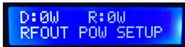
5.c.- Esto nos indica que estamos en posición de bajar o subir la POTENCIA de transmisión. En este momento no realizaremos ningún cambio de potencia. Recuerde que la potencia está en cero watts por lo que aún no podemos modificar esta magnitud.
